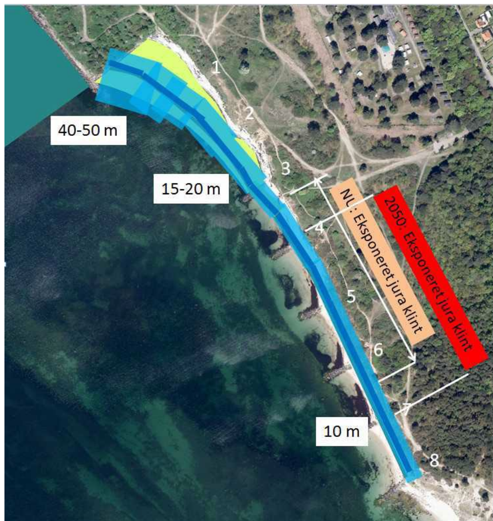
Figur 4: Den mørkeblå linje viser den forventede nye kystlinje (ligevægts-kystlinjen) efter etablering af ydermolen. Den lysere blå zone omkring ligevægts-kystlinjen viser, hvordan kystlinjen forventes at bevæge sig de næste 40-50 år. Figuren viser, at kystlinjen vil bevæge sig inden for et 10 m bredt felt i den sydlige del ud for høfderne 5-8, stigende til 15-20 m ud for høfde 3 og 40-50 m i den nordlige del af sandfodringen lige syd for den nye mole.
